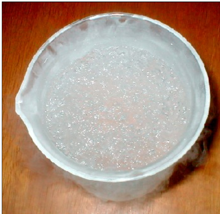
Et glas flydende kvælstof placeret på et bord. Bordet virker som en kogeplade, der får kvælstoffet til at koge kraftigt.
