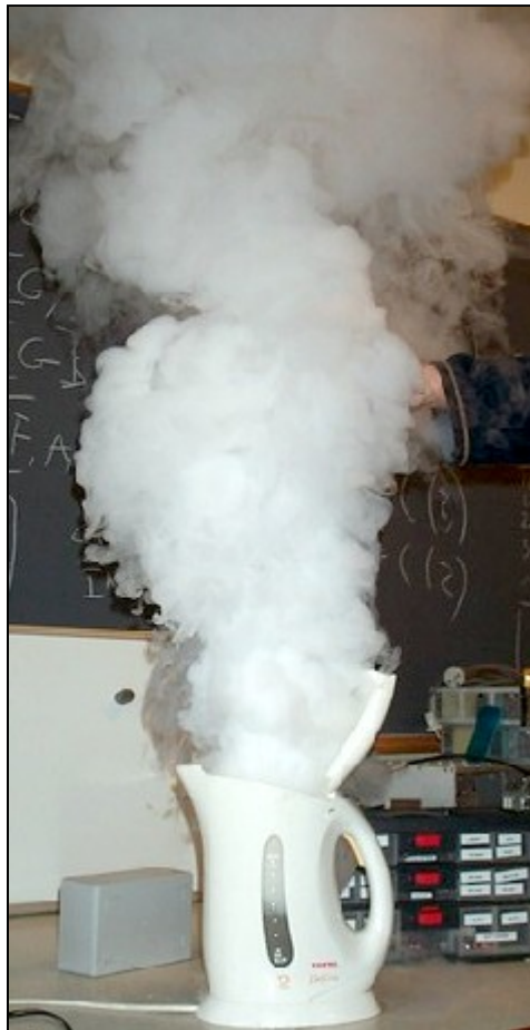
Billede af skydannelse med flydende kvælstof. Kvælstoffet hældes i en elkedel med varmt vand.
